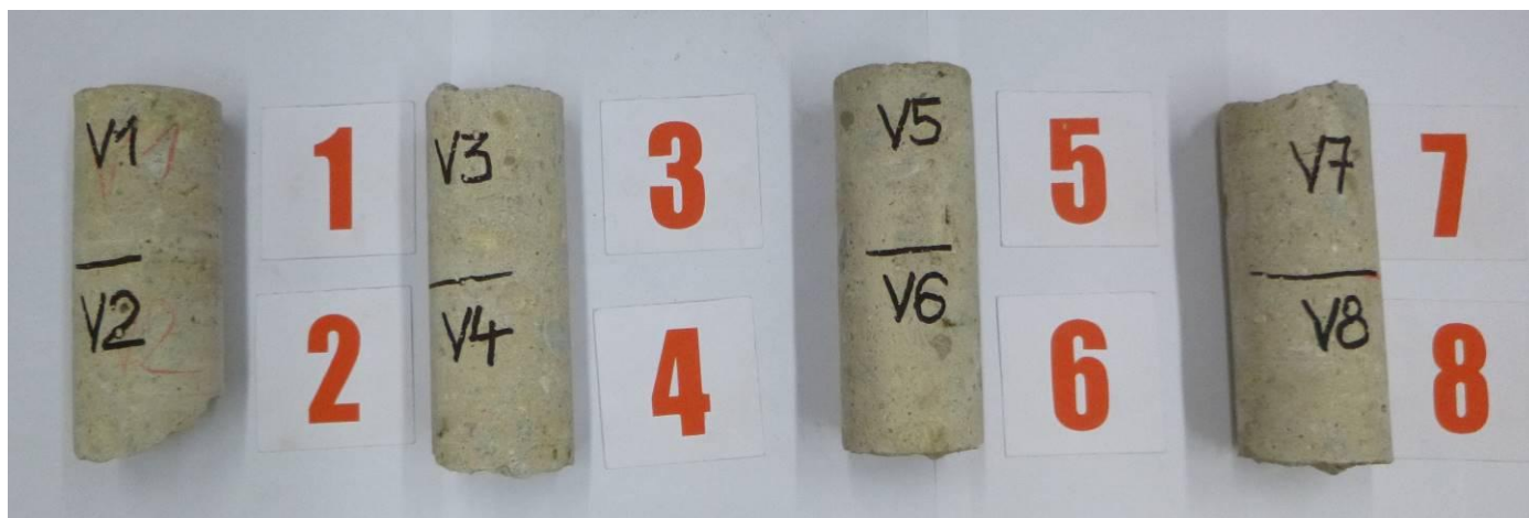
FOTO č.3.1.4: Dokumentace vývrtů pro destruktivní zkoušky pevnosti v tlaku betonu
