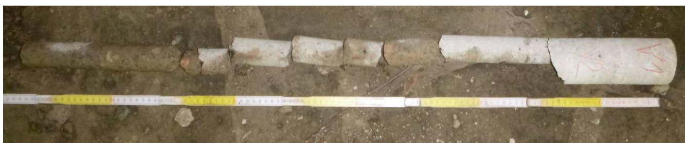
FOTO 3.3.3: Dokumentace vývrtu VO1 ke zjištění tloušťky opěry 1
